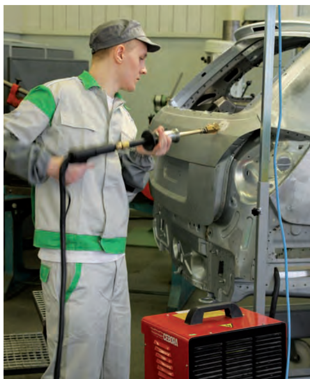
❶ Kategorie Karosář – oprava dílu pomocí spotovacího zařízení.
