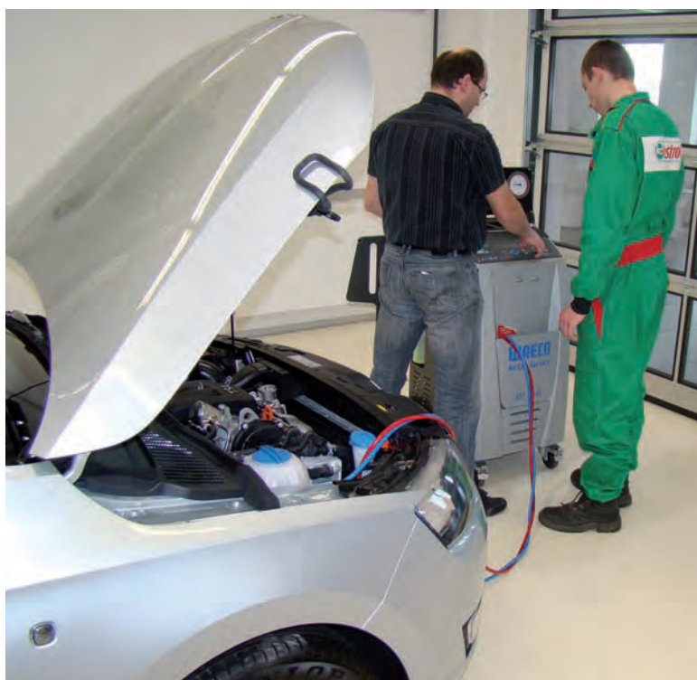
❷ Jeden z úkolů pro autotroniky – servis klimatizace na vozidle.
